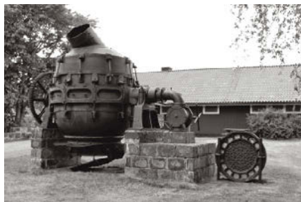
Doc. 3 – Conversor de Bessemer (1856). Permitia purificar o ferro em apenas 20 minutos – processo que costumava demorar um dia inteiro.
