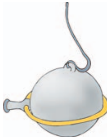
A esfera, depois de aquecida, não passa no anel.
