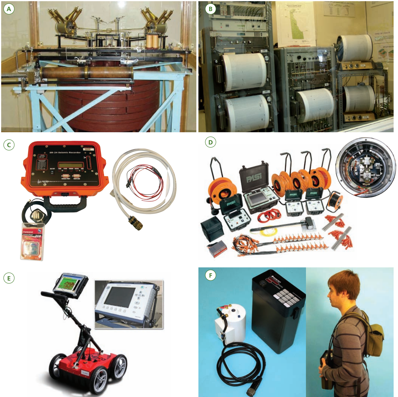
13 Tecnologia utilizada na vigilância sísmica: sismógrafo horizontal Wiechert com 1200 kg, de 1910 [A]; sismógrafo moderno eletromagnético [B]; estação sísmica ultraportátil [C]; equipamento de refração/reflexão sísmica [D]; georadar TerraSIRch SIR-3000 [E]; magnetómetro Geometrics G-856 Magnetometer [F].
