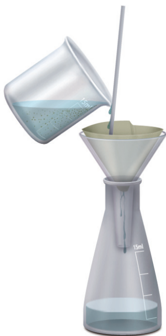
[10] Montagem para filtração com papel de filtro, usada no laboratório.
