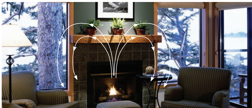
[7] Aquecimento do ar de uma sala através de correntes de convecção.
