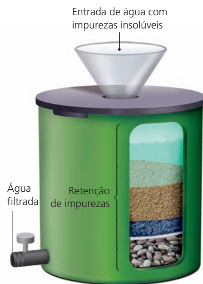
[12] Constituição de um filtro de areia usado na purificação de água potável.
