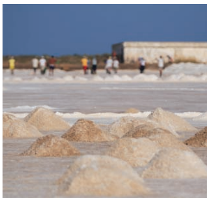
14 Salina, onde o sal é separado da água do mar por evaporação.
