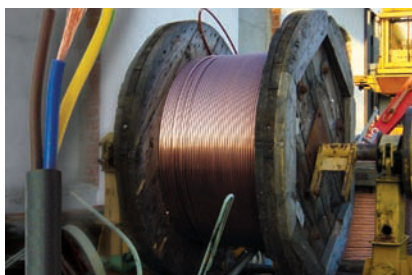
2 O cobre pode ser deformado para obter fios usados nos condutores elétricos.
