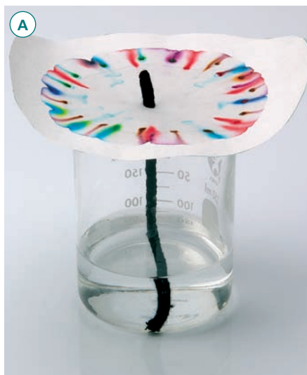
18 Cromatografia [A] e cromatograma [B]. A tinta arrastada pelo solvente apresenta duas cores que identificam os constituintes da mistura.
