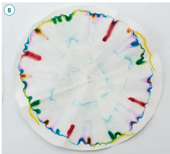
18 Cromatografia [A] e cromatograma [B]. A tinta arrastada pelo solvente apresenta duas cores que identificam os constituintes da mistura.
