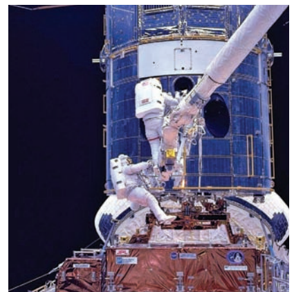
14 Operação de reparação no espaço do telescópio Hubble .
