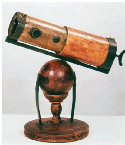
9 Telescópio refletor de Newton, construído com espelhos em vez de lentes.
