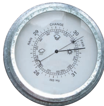
[26] O barómetro é o aparelho de medição da pressão atmosférica. A unidade utilizada é o hectopascal (hPa) ou os milibares (mb).
