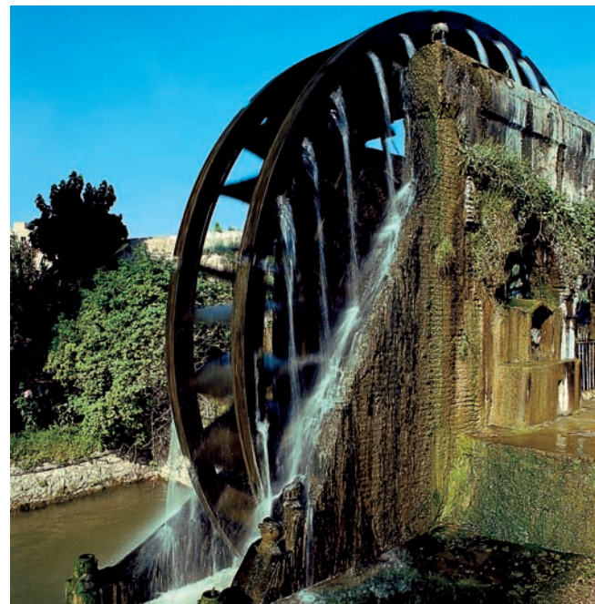
7 Nora, elevando a água do rio para um aqueduto.
