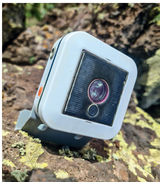
Figura 1. Fotómetro. Créditos fotográficos: Tiago Dias.
