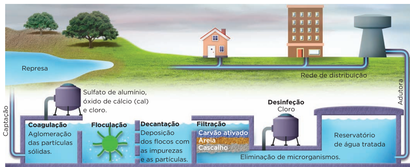
Fig. 50 Esquema de funcionamento de uma ETA.
