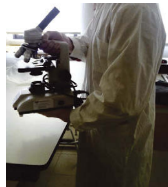
Fig. 2 O transporte do MOC deve ser realizado com uma das mãos na base e a outra no braço ou coluna.
