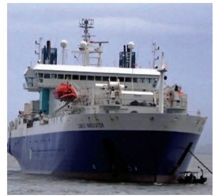
Fig. 26 O navio Cable Innovator , responsável pela colocação de cabos submarinos de fibra ótica.
