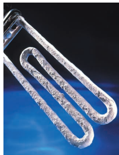
Fig. 14 Depósito de calcário na resistência de uma máquina.
